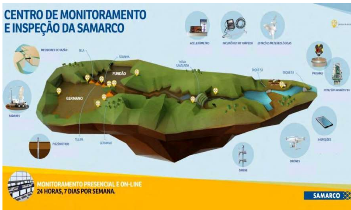
Figura 4.7 – Infográfico do sistema de monitoramento do Centro de Monitoramento e Inspeção Geotécnico da Samarco (CMI).
