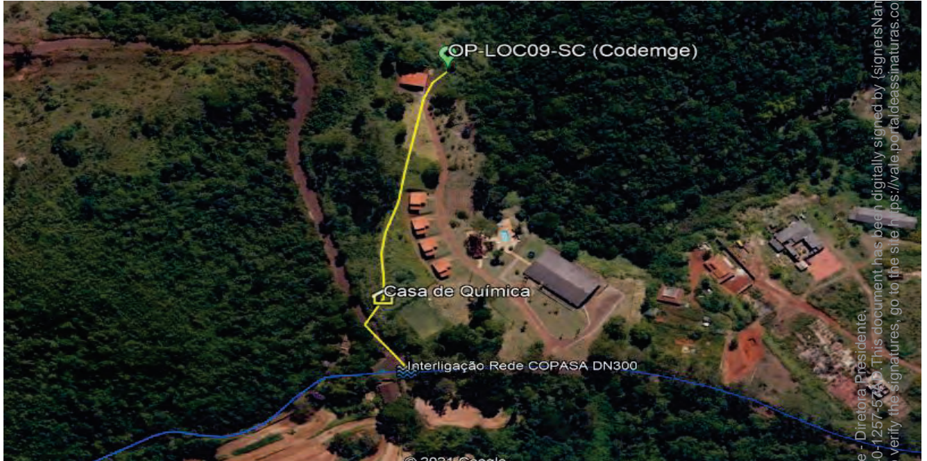
Figura 5 - Interligação poço tubular Clube CODEMGE
