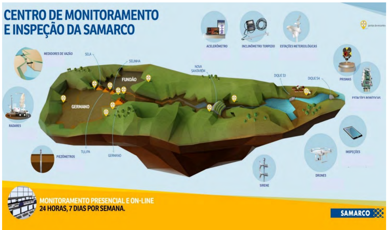
Figura 10: Infográfico do sistema de monitoramento do Centro de Monitoramento e Inspeção Geotécnico da Samarco (CMI).
