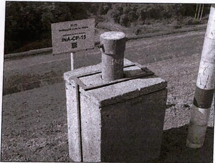
Foto 8 – Detalhe para a identificação por código QR na placa de identificação do instrumento.
